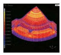
La seguridad y confiabilidad de nuestros productos están asegurados utilizando lo ultimo en tecnología de calculación FEM- las simulaciones de operación interactiva durante la fase completa de diseño; esto asegura que todas las tensiones de motor sean consideradas mucho antes que nuestros componentes estén en operación.
